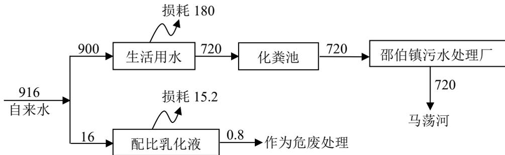
图 4-3 项目全厂水平衡图 (单位: m<sup>3</sup>/a)
