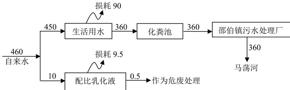
图 4-2 本项目水平衡图 (单位: m<sup>3</sup>/a)
