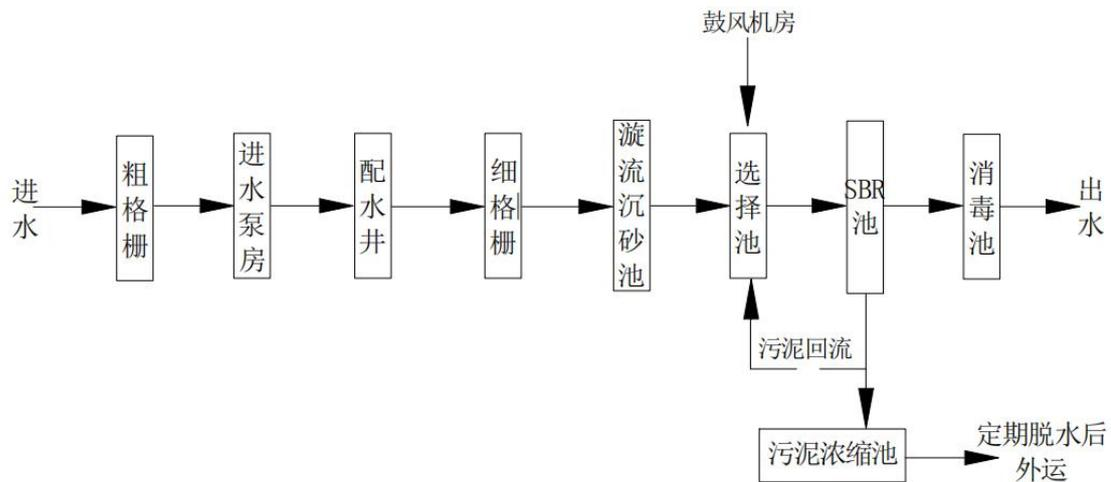
图 4-4 邵伯镇污水处理厂污水处理工艺流程图
