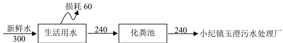
图 4-1 项目水平衡图 (t/a)
