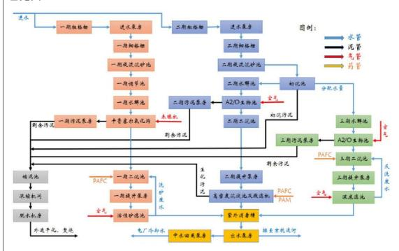
图 4-2 污水处理工艺流程图
